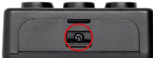
Anschließend können 4 x AAA – Batterien eingelegt werden und das Batteriefach kann wieder hineingeschoben und festgeschraubt werden.
