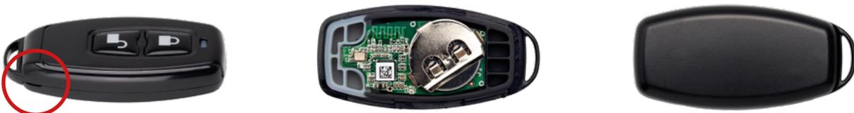
Um die Batterie zu wechseln, muss zunächst das Gerät geöffnet werden. Dafür stecken Sie vorsichtig einen Schlitz – Schraubendreher in die Öffnung des Gehäuses, die sich auf der unteren Seite der Fernbedienung befindet. Drücken Sie nun vorsichtig die beiden Abdeckungen auseinander, bis das Gehäuse geöffnet ist.
